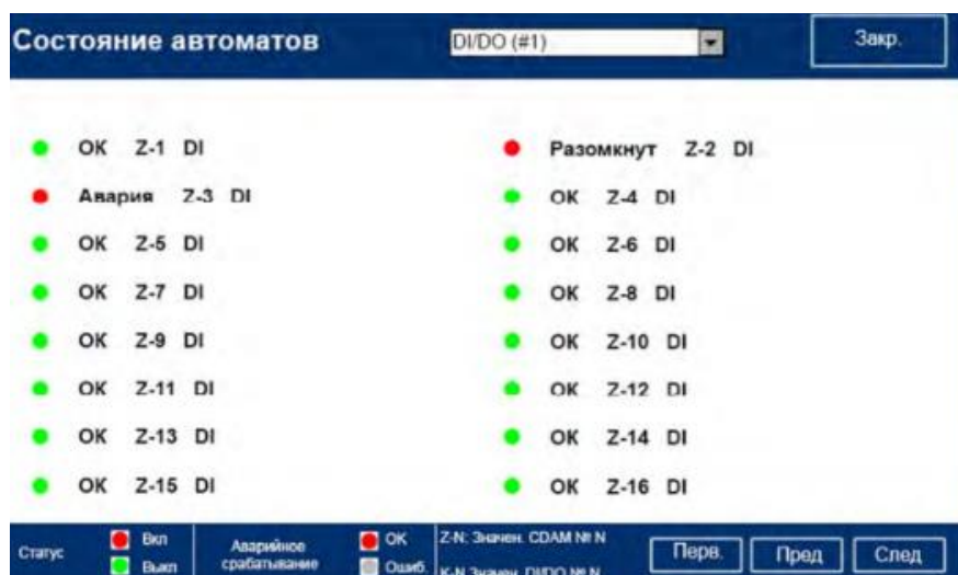
Рисунок 1.13 – Информация о положении выключателей на цифровых входах.
